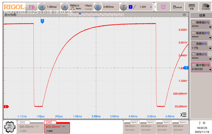
Figure 6: 零状态响应示波器观测结果 (1)
