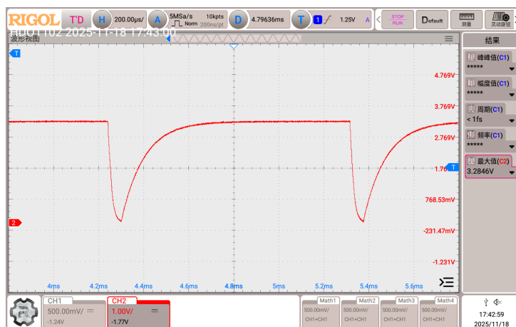
Figure 7: 零状态响应示波器观测结果 (2)
